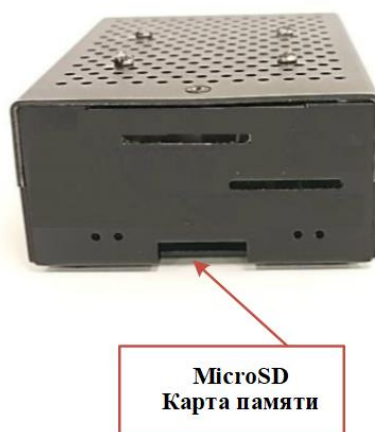
Рисунок 4 — Размещение соединителей на задней панели Изделия Микрокомпьютер «Скиф-МП»
