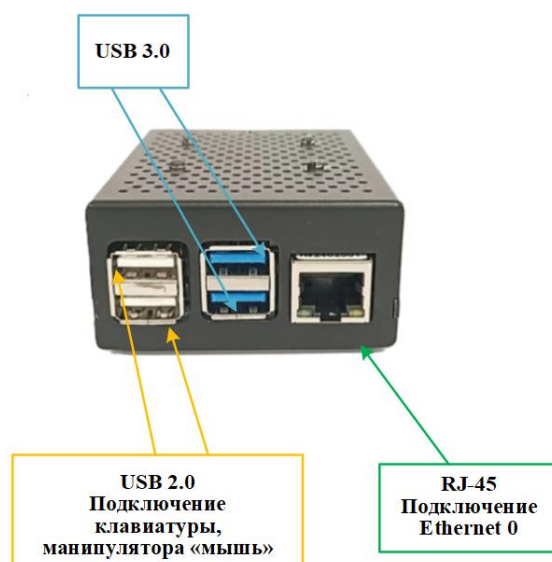
Рисунок 3 — Размещение соединителей на передней панели Изделия Микрокомпьютер «Скиф-МП»
